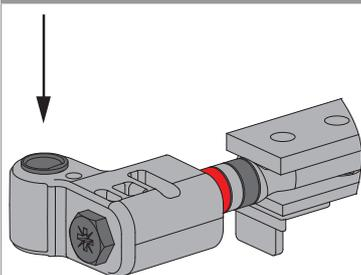
La costruzione fra supporto forbice, angolo forbice e perno supporto forbice fa frenare l'anta aperta e aggrave la chiusura autonoma.
