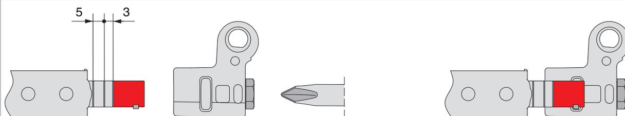
**Montaggio:** inserire l'angolo forbice in posizione corretta sul perno forbice e avvitare con un cacciavite a croce o un avvitatore elettrico fino a serrare.
