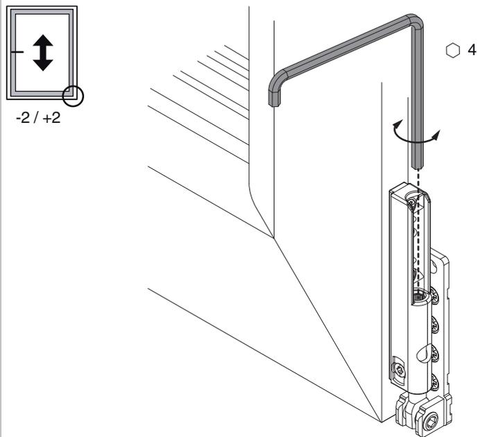
• **Regolazione:** l'angolo cerniera può essere regolato in altezza utilizzando una chiave a brugola da 4 mm, cod. 41017. Per migliorare la praticità di utilizzo, la vite di regolazione dell'altezza è stata costruita in modo che la chiave a brugola possa essere agganciata ogni 30°. In tal modo viene regolata l'altezza dell'anta.
